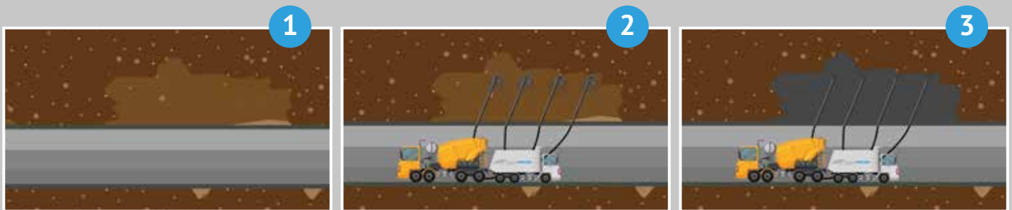
Underground Void Fill
